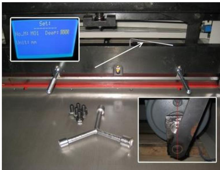
В данном методе достаточно соприкосновения кромки ножа с марзаном. Прикрутите сверху торцевые регулировочные винты (**Balance screws**) вплотную к телу ножа без усилия, создавая для него упор. Теперь можно снять держатели ножа и затянуть все крепежные винты.
