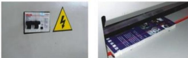
Включите электропитание. При этом загорится индикатор включения питания и будет подан звуковой сигнал. Резак автоматически произведет калибровку (настройку механизмов), переместив при этом затл до упора назад и обратно. Резак готов к работе.
